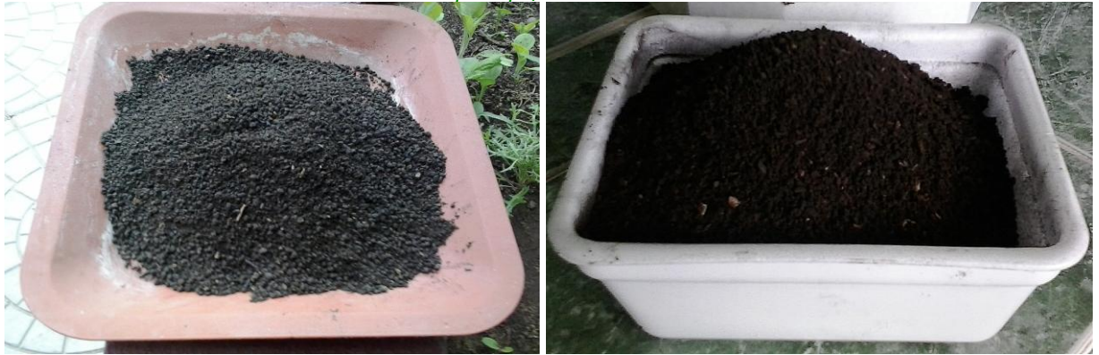
Рис. 51. Почвообразователь из сапропеля и сапропеле-торфяной смеси в пропорции 1:3 для рекультивации и восстановления истощенных земель. Продукт проучен путем дезинтеграции сырья в требуемых пропорциях на оборудовании ДС-1099-3000
